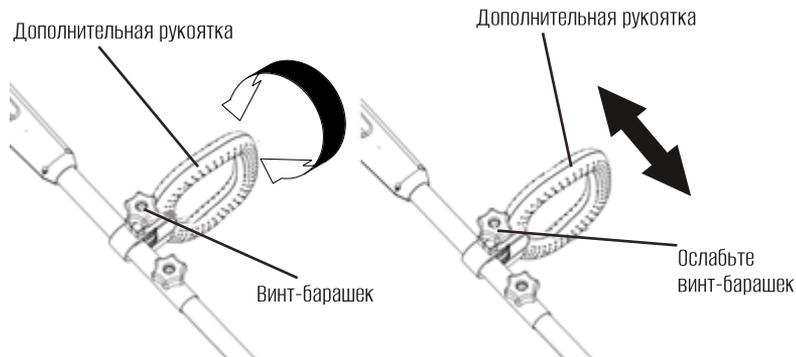
3. Зафиксируйте рукоятку, затянув винт-барашек. Подключите к сети и возобновите работу.
