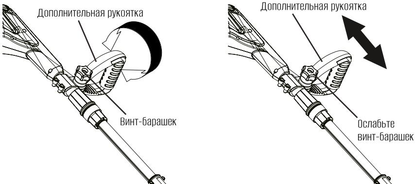
3. Зафиксируйте рукоятку, затянув винт-барашек. Вставьте аккумулятор и возобновите работу.
