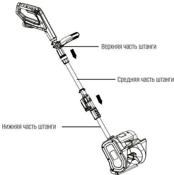
Вставьте ручки для фиксации соединений в совмещенные отверстия в опорах и закрепите другой конец с шайбами и ручками фиксации соединения.
