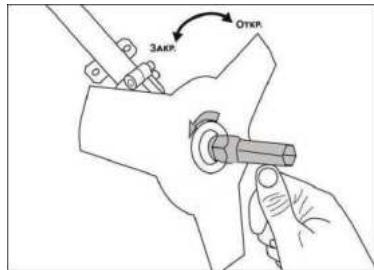
**ВНИМАНИЕ!** При неправильной центровке режущего ножа в процессе работы возникает сильная вибрация, в результате чего возможна поломка триммера или режущий нож может отлететь в сторону, причинив травмы пользователю или посторонним лицам.
