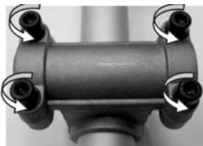
Снимите верхнюю половину крепления рукоятки к штанге
