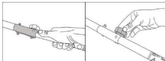
С помощью шестигранного ключа открутите 4 винта крепления рукоятки управления к штанге
