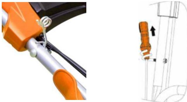
8. Закрепите на рукоятке тросы рычагов управления двигателем и привода движения при помощи имеющегося на рукоятке фиксатора.
