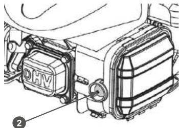
1. Проверьте уровень масла в картере двигателя и наличие топлива в топливном баке.
