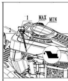
**ВНИМАНИЕ!** После заправки, замены или проверки уровня масла визуальным осмотром проверяйте отсутствие протечек масла из картера.
